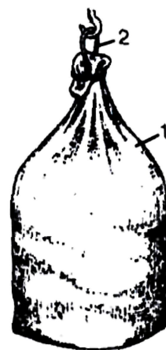
Р и с. 67. Контейнер МКР-М: 1 — корпус; 2 — грузовой канат
